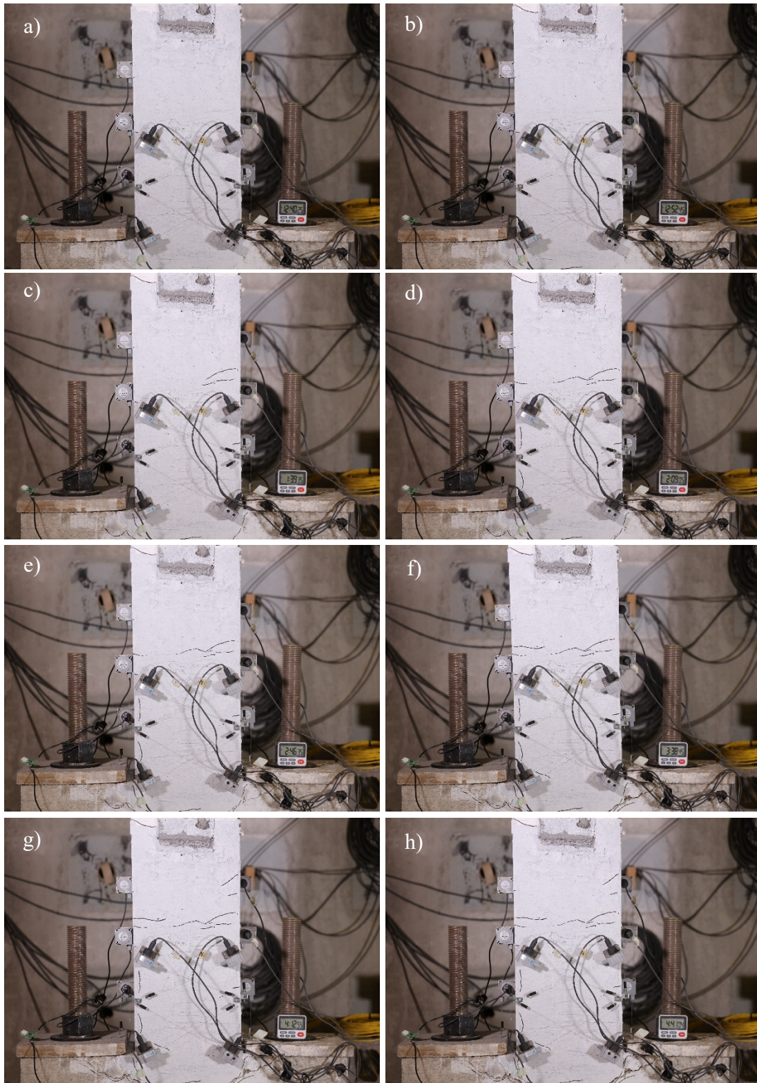
Figure 7.18. CT1-15M-R at drift ratios: a) 0.25%; b) 0.5%; c) 1%; d) 1.5%; e) 2%; f) 2.5%; g) 3%; h) 3.5%.
