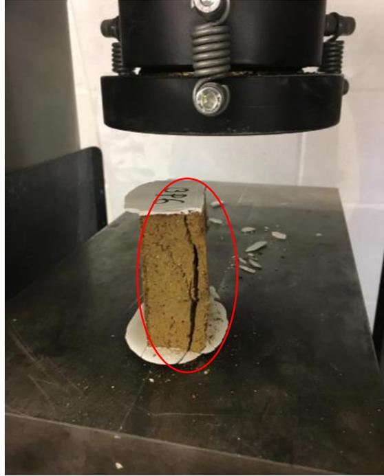
Figure 5-39: Failure crack pattern of DHBS
